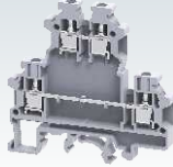
ODL4U 63 x 68 x 6 mm 0.2 - 4.0 mm 2 32 A, 800 V, 0.5 Nm
