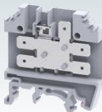
CTC4U 49.5 x 47 x 6 mm 0.2 - 4.0 mm 2 6.3 x 0.8 mm Tab 32 A, 300 V
